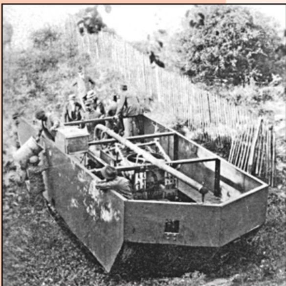
Het prototype van de Saint-Chamond tank, van achteren gezien, gebouwd door de Service Technique Automobile van het Franse leger.
