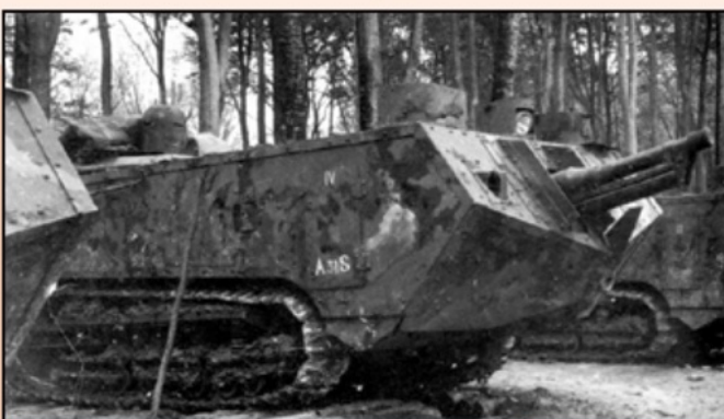
Een Saint-Chamond van het eerste type. In de middelste (ventilatie) cilinder is een schijnwerper geplaatst.
