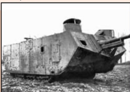
Het prototype van de Saint-Chamond tank. De pantsering van de zijanten loopt nog door tot over het onderstel, bij de productievoertuigen zou de pantsering om gewicht te besparen niet verder gaan dan tot boven de rupsbanden.
